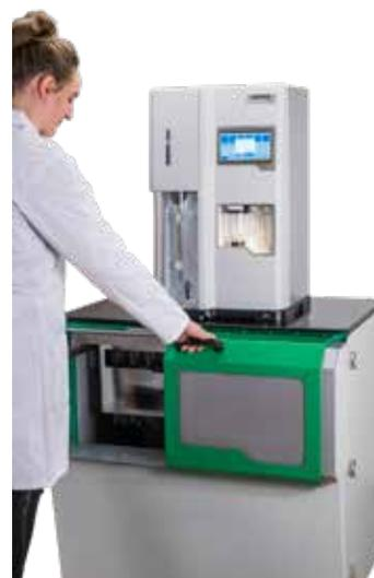
IT IS EASY TO INSERT A TUBE RACK INTO THE AUTOSAMPLER. A FRONT DOOR PROTECTS THE OPERATOR DURING OPERATION.
